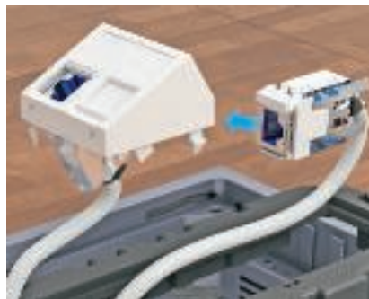
Вграждане на свързан модул за пренос на данни Щекнете модула за пренос на данни след свързването на проводника от задната страна в носещата платка. Завинтайте носещата платка към монтажния носач.
