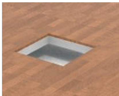
Монтиране на подовата настилка Положете подовата настилка до ръба на монтажния капак.
