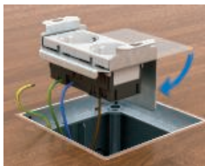
Монтаж на контакта в носач Щракнете контакта в металния носач и го свържете. След свързването на заземителния проводник огънете металния носач на 90°.
