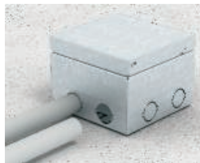
Свързване на инсталационните тръби Въведете тръбите M25 максимум на 5 mm дълбочина в елемента.
