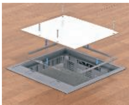
Настройка на вдлъбнатината за подова настилка на 8 mm при "GES4-2", "GES6-2" и "GES9-2" Развийте четирите болта на капака и поставете в 2 мм-овата дистанцираща рамка 5 мм-овия дистанциращ капак. Отново завийте капака от стоманена ламарина.
