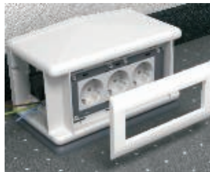
Инсталация на контакти Модул с покрития S990 45 в T4L и T8NL Подгответе отворите за проводници в конзолата Telitank T4L и закрепете в кутията. Преди свързването на проводника монтирайте контакта Модул 45 в адаптера на Telitank. Закрепете покриващата платка S990 отвън в кутията.
