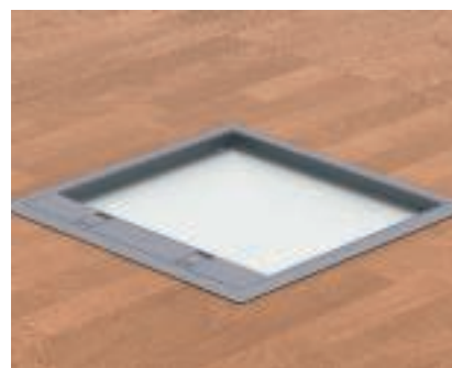
Настройка на вдлъбнатината за подова настилка на 10 mm при "GES4-2", "GES6-2" и "GES9-2" Развийте четирите болта на капака и поставете в 2 мм-овата дистанцираща рамка 5 мм-овия дистанциращ капак. Отново завийте капака от стоманена ламарина.
