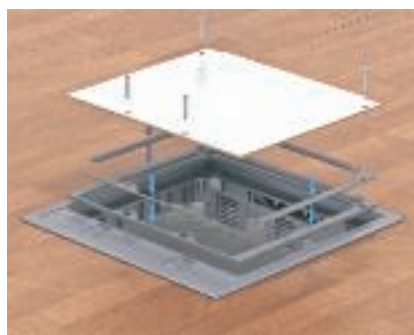
Настройка на вдлъбнатината за подова настилка на 3 mm при "GES4-2", "GES6-2" и "GES9-2" Развийте четирите болта на капака и поставете в 2 мм-овата дистанцираща рамка 5 мм-овия дистанциращ капак. Отново завийте капака от стоманена ламарина.
