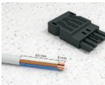
Подготовка на присъединителен проводник за подповод разклонител с щепселна връзка Свържете присъединителния проводник към 5-полюсната буксова част.
