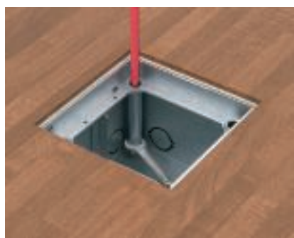
Настройка на горния ръб на готовия под Настройте височината и осигурете болтовете за нивелиране с контрагайка.
