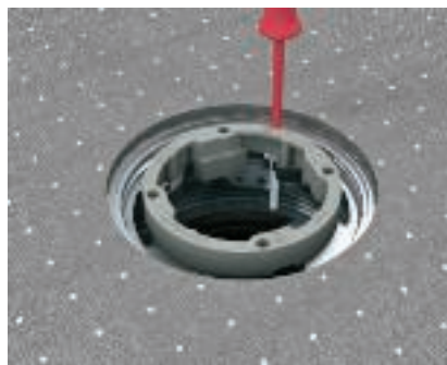
Монтаж на Telitank върху подподова изход US80 и подподова кутия UDL2-80 Завъртете вътрешно разположения монтажен пръстен в горната област на изхода и го фиксирайте чрез завинтването на затягащия винт. Положеният дистанционен пръстен би трябвало да лежи приблизително подравнен с горния ръб на готовия под.
