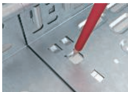
Надлъжно безболтово съединение, необходимо е само огъване на пластините на дъното
