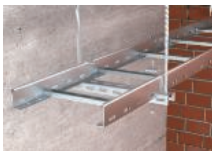
Монтаж върху подложен профил със затягащ елемент, болтове с обла глава и широкополи подложни шайби
