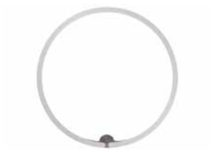
Отвор с необработен заваръчен шев
